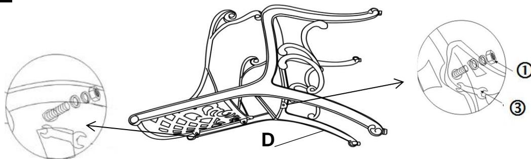
Répéter le même process d'assemblage pour le pied Gauches(D).
