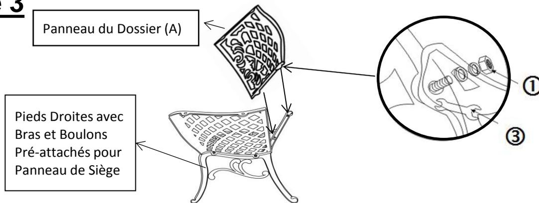
Ensuite attacher l'Appui Dos (A) aux Pieds Droites (C) en utilisant les Rondelles, Rondelles Elastiques et Boulons (①), avec l'aide du Clef(③).
