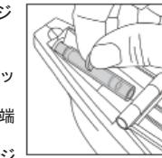
補修対象物の色に最も近い色のPermaFillカートリッジを選びます。カートリッジ装着部の蓋を開け、ハンドルを持ち先端から器具に取り付けます。その後、内部のラムが邪魔になる場合は、カートリッジリリースボタンを押してラムをもとの位置に戻します。カートリッジを器具の中に完全に押し込みます。
