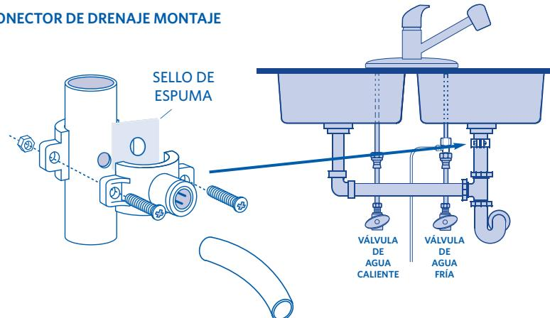
Nota: Se debe tener mucho cuidado al ingresar a los desagües que estén cerca de las máquinas lavaplatos o de los trituradores de desperdicios ya que puede ocurrir flujo de retorno a través del espacio de aire y ocasionar inundación.
