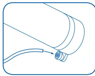
**Conecte el tubo rojo de 3/8" del grifo de ósmosis inversa al adaptador del drenaje**
