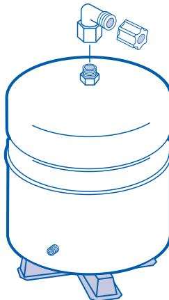
Regule la presión de aire del tanque para que quede entre 5 y 7 psi.
