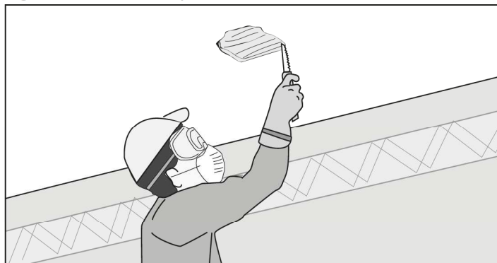
Fig. 6 Élargir le trou de départ de façon à voir la solive.
