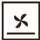
Ventilador y calentador inferior encendidos
