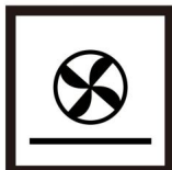
Ventilateur de chauffage circulaire avec élément inférieur
