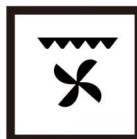
Ventilador, elemento de parrilla
