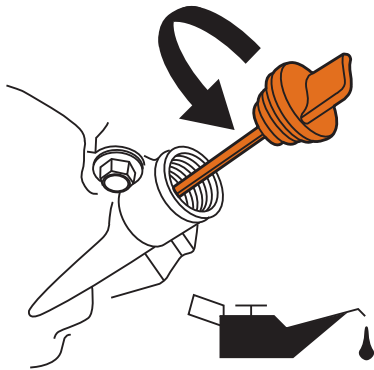
Figura 36 – Llenado de aceite del motor
