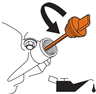
Figure 36 - Remplir l'huile à moteur
