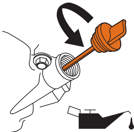
Figure 6 - Remplir l'huile à moteur
