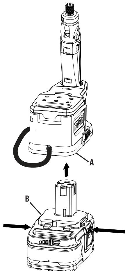
A - Battery port (logements des pile, puerto de batería)
