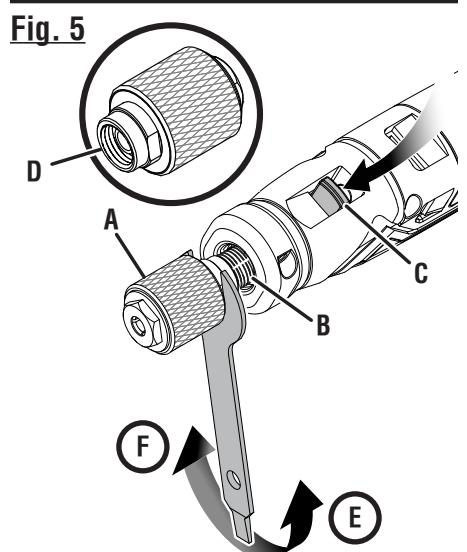
A - Quick-change collet (collet à changement rapide, portaherramientas de cambio rápido)
