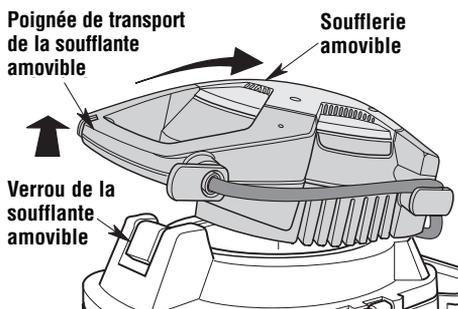
2. Pour remettre la soufflante amovible sur l'ensemble de couvercle, positionnez la soufflante amovible au-dessus de la partie en retrait de l'ensemble de couvercle. Faites tourner la soufflante amovible vers le bas jusqu'à la fin de la course du dispositif.
