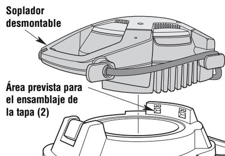
3. Presione ligeramente hacia abajo sobre el asa de transporte del soplador desmontable hasta que oiga el "golpe seco" que se produce cuando el pestillo para el soplador desmontable se acopla a dicho soplador desmontable. Después de esto, el soplador desmontable estará sujeto al ensamblaje de la tapa.
