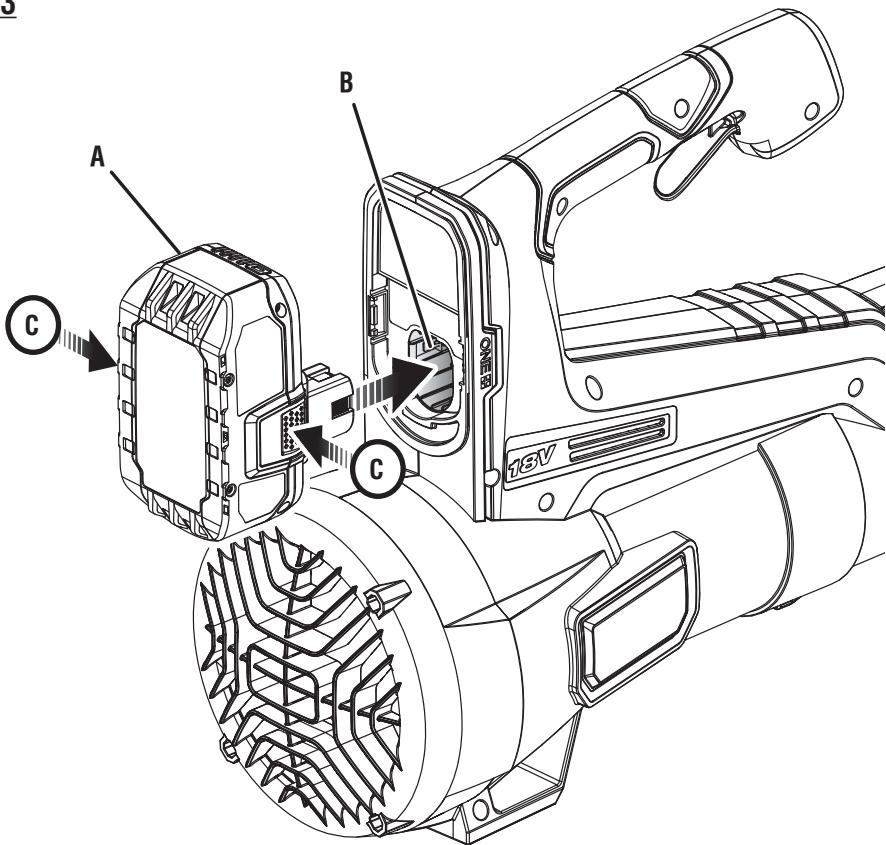
A - Battery pack (bloc-piles, paquete de baterías)
