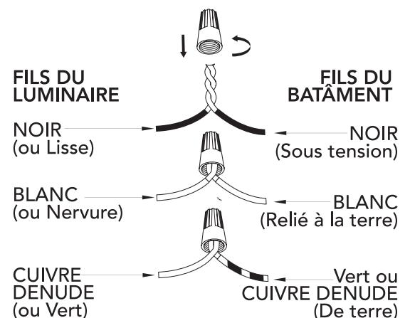
(vert ou cuivre). Torsadez l'extrémité des paires pour les connecter ensemble. Placez ensuite ces fils torsadés sous un capuchon de connexion. Veillez à ce que la torsion soit toujours dans la même direction. Enroulez le fil de terre de l'appareil autour de la vis de mise à la terre (E) et serrez. S'il n'y a pas de fil de terre (vert ou cuivre) dans la boîte de jonction, adressez-vous à un électricien qualifié.
