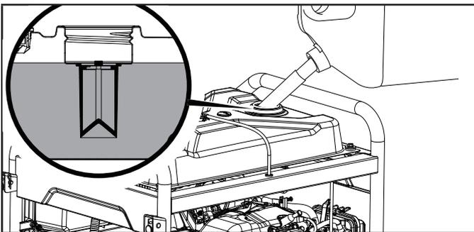
3. El nivel de combustible aproximado se muestra en el medidor de combustible en la parte superior del tanque de combustible.
