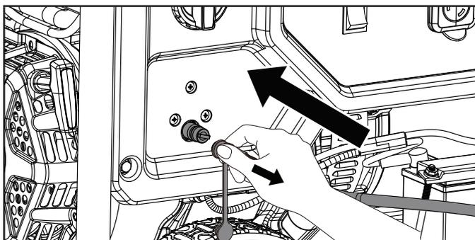
4. Conecte el otro extremo de la manguera al conector de GLP en el cilindro y apriete con la mano.
