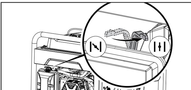
9. Oprima y mantenga oprimido en la posición "ARRANCAR" por durante un máximo de 5 segundos o hasta que se enciende.
