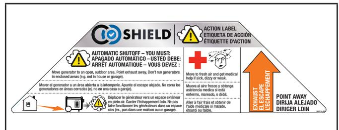
Cuando se acerque al generador para investigar un apagado, una luz LED **roja** destallando en el area del CO Shield provee la notificación que el generador se apago debido a una acumulación peligrosa de CO. La luz roja LED destallará por lo menos cinco (5) minutos después de un evento de apagado.
