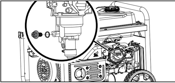
5c. Cuando la gasolina pare de fluir del carburador, reemplace y apriete el perno de drenaje del carburador y asegúrese de deshacerse de la gasolina drenada en acuerdo con las regulaciones y normas locales.
