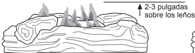
Fig. 22 - Patrón correcto de la llama del quemador
