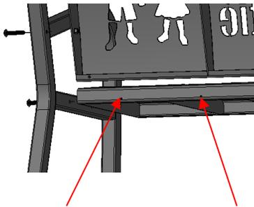
Notez l'emplacement des trous d'évacuation d'eau sur chaque partie du banc. Pour le siège, lorsqu'il est fixé aux cadres latéraux, les trous doivent être orientés vers l'arrière.
