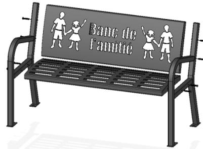
À l'aide du matériel (articles 4 et 5) et de l'embout cruciforme fournis (article 6), montez le siège (article 1) sans trop serrer aux (2x) cadres latéraux (article 3). **Remarque :** ceci se fait plus facilement à deux.
