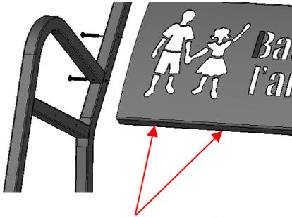
Notez l'emplacement des trous d'évacuation d'eau sur chaque partie du banc. Pour le dossier, les trous doivent être orientés vers le bas lorsque l'on fixe le dossier aux cadres latéraux.
