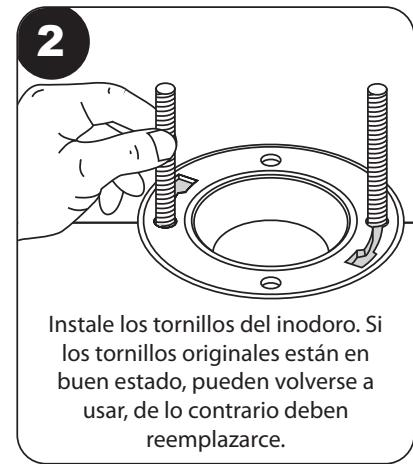
Instale los tornillos del inodoro. Si los tornillos originales están en buen estado, pueden volverse a usar, de lo contrario deben reemplazarse.
