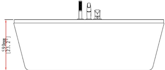
2A. Dévissez les boulons en bas de la baignoire à l'aide d'une clé ajustable. Ensuite, démontez doucement la partie supérieure de la baignoire et placez-la sur une protection pour éviter d'endommager le sol ou la baignoire.
