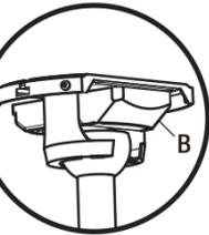
Receptor (B) correctamente colocado en el soporte de montaje.
