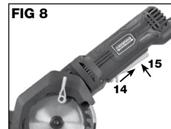
**Pour mettre la scie en MARCHE**, Tirer la gâchette de verrouillage (14) dans le sens indiqué à la FIG 8, puis appuyer sur le commutateur (15).
