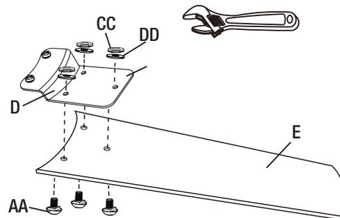
Los ensamblajes de las aspas deben acoplarse al motor utilizando los tornillos (1) de retención pre-instalados en el soportes de las aspas (D). El procedimiento para acoplar los ensamblajes del asa es el siguiente :
