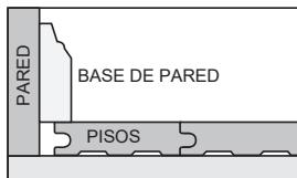
**Base de pared:** Se usa para dar aspecto acabado a la base de las paredes. Puede usarse con o sin cuarto bocel.
