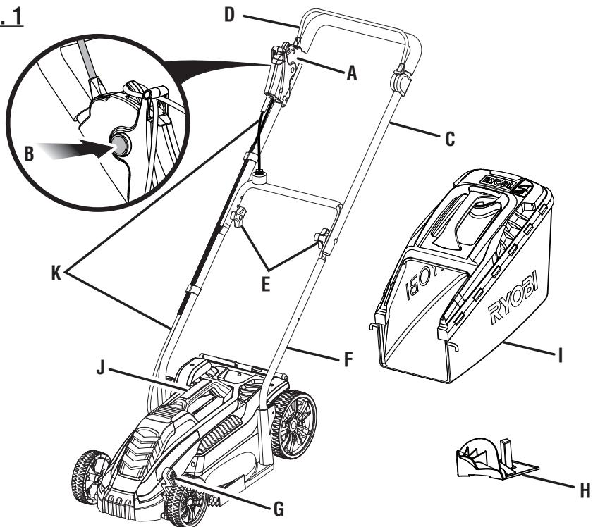
A - Motor/blade control assembly (dispositif de commande du moteur/de la lame, conjunto de control del motor/hoja)
