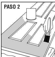
Las pinceladas deben seguir la dirección del grano del área seleccionada. Empiece por los paneles y molduras (perfiles moldeados), luego siga con el entrepaño central vertical, los travesaños horizontales, los montantes verticales y, finalmente, los bordes externos (montantes y travesaño superior, ver detalles en la Figura 1).
