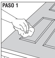
**Las puertas de fibra de vidrio** deben limpiarse con un solvente, alcoholes minerales guerrás. Deje que el solvente se seque completamente, hasta que no haya olor residual. A continuación, hay que lavar la puerta con un detergente suave en agua jabonosa tibia, enjuagarla y, finalmente, secarla.
