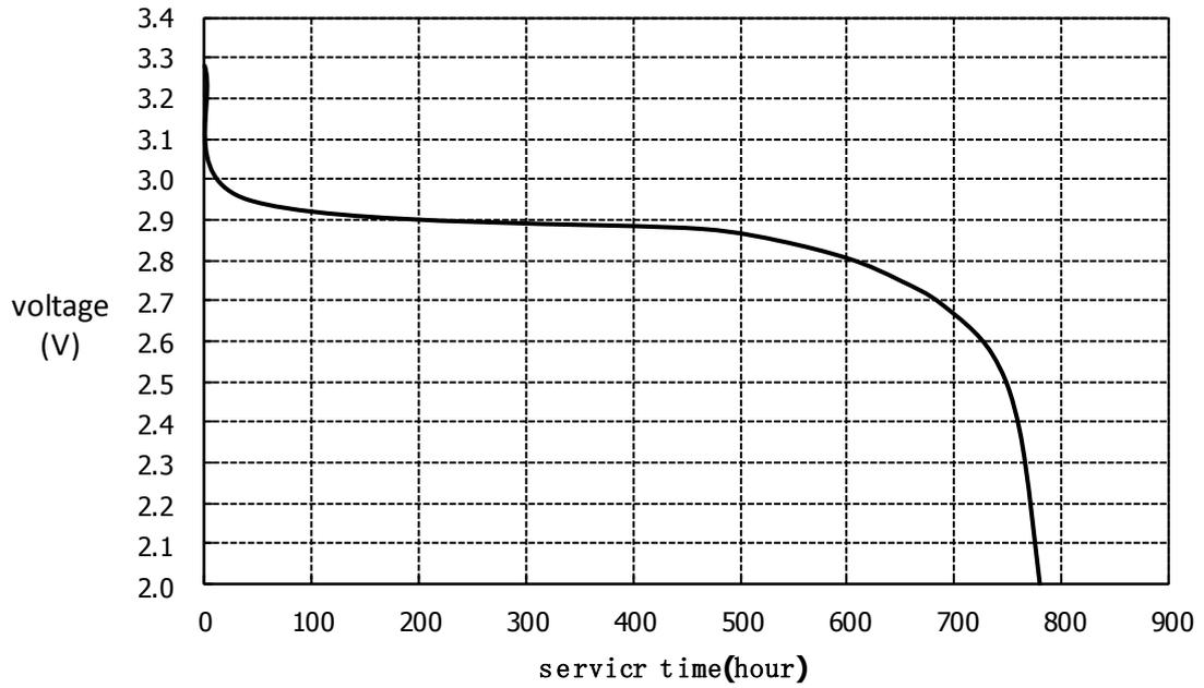
Discharge method: 15K $\Omega$ , 24 hours/day EV 2.0VMéthode de décharge: 15K $\Omega$ , 24 heures/jour EV 2.0Vtemperature of 20 $\pm$ 2 $^{\circ}$ Ctempérature de 20 $\pm$ 2 $^{\circ}$ C
