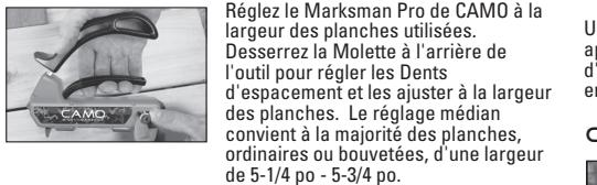
Réglez le Marksman Pro de CAMO à la largeur des planches utilisées. Desserrez la Molette à l'arrière de l'outil pour régler les Dents d'espacement et les ajuster à la largeur des planches. Le réglage médian convient à la majorité des planches, ordinaires ou bouvetées, d'une largeur de 5-1/4 po - 5-3/4 po.
