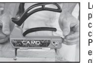
Lorsque l'outil est en place sur la planche, insérez une pièce de fixation cachée CAMO dans les Guide-vis à chaque extrémité de l'outil Marksman Pro. Remarque : Si l'outil n'est pas bien en place sur la planche, les vis glisseront hors du Guide-vis.
