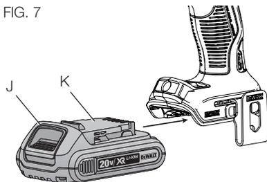
con los rieles dentro del mango de la herramienta y deslícelo hacia el interior del mango hasta que el paquete quede asentado con firmeza en la herramienta. Asegúrese de que no se desenganche.
