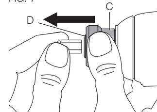
**Para instalar un accesorio**, insértelo completamente. El accesorio encaja en su sitio (Fig. 6).
