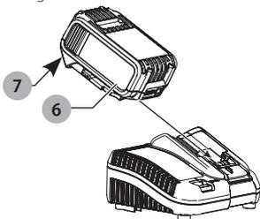
2. Inserte la batería **6** en el cargador, comprobando esté bien fija. La luz roja (de carga) parpadeará continuamente para indicar que se ha iniciado el proceso de carga.
