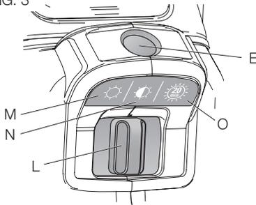
En los ajustes bajo y medio, el haz se apagará automáticamente 20 segundos después de liberar el interruptor de gatillo.
