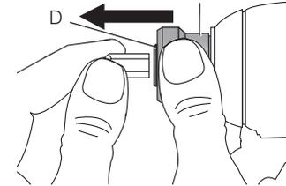
**Pour installer un accessoire,** insérez-le à fond dans le mandrin. Il sera alors verrouillé en place (Fig. 6).
