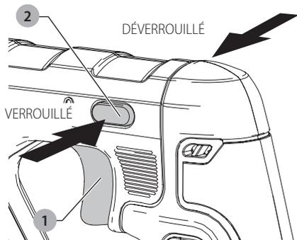
**AVERTISSEMENT** : cet outil n'est pas équipé d'un bouton de verrouillage pour le maintenir en position de marche, et ne doit en aucune manière être verrouillé par tout autre moyen.
