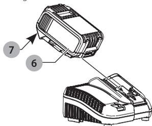
2. Insérer le bloc-piles **6** dans le chargeur, en vous assurant qu'il y est correctement calé. Le voyant rouge (charge) clignotera de façon continue indiquant que le cycle de chargement a commencé.
