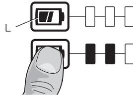
**REMARQUE :** le témoin de charge ne fait qu'indiquer le niveau de charge du bloc-piles. Il ne donne aucune indication quant au fonctionnement de l'outil. Son propre fonctionnement pourra aussi varier en fonction des composants produit, de la température et de l'application d'utilisation.
