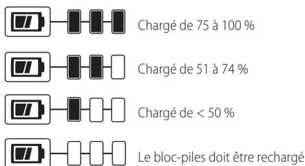
Pour activer le témoin de charge, maintenez appuyé le bouton du témoin de charge. Une combinaison des trois voyants Del verts s'allumera indiquant le niveau de charge. Lorsque le niveau de charge du bloc-pile atteint la limite minimale d'utilisation, le témoin de charge reste éteint et le bloc-piles doit être rechargé.
