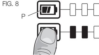
**NOTA:** El medidor de carga es solo un indicador de la carga restante en el paquete de baterías. No indica la funcionalidad de la herramienta y está sujeto a variaciones según los componentes del producto, la temperatura y la aplicación del usuario final.
