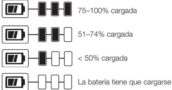
Para activar el indicador de carga, presione y sostenga el botón del indicador (L). Se iluminará una combinación de las tres luces LED verdes, que indicará el nivel de carga que queda. Cuando el nivel de carga esté por debajo del nivel útil, el indicador no se iluminará, y la batería deberá recargarse.
