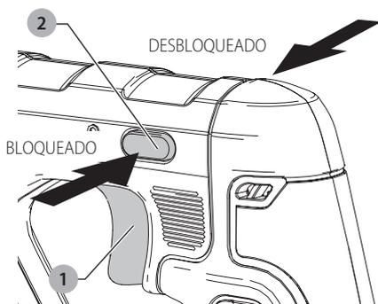
**ADVERTENCIA:** Esta herramienta no tiene ningún dispositivo que bloquee la herramienta en ON (encendida) y no debería ser bloqueada en ON de ninguna manera.
