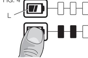
**NOTA:** El indicador de carga es sólo eso: un indicador de la carga de la unidad de alimentación. No indica el nivel de funcionalidad de la herramienta y puede variar de acuerdo a las piezas del producto, la temperatura y la aplicación que el usuario le dé.
