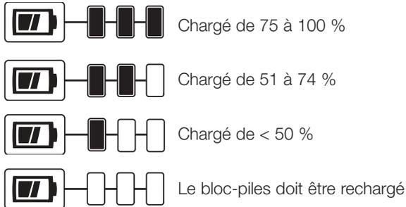
Pour activer le témoin de charge, maintenez appuyé le bouton du témoin de charge (L). Une combinaison des trois voyants Del verts s'allumera indiquant le niveau de charge. Lorsque le niveau de charge du bloc-pile atteint la limite minimale d'utilisation, le témoin de charge reste éteint et le bloc-piles doit être rechargé.
