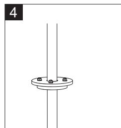
**NOTA:** NO DEBE permitir que el montaje se deslice hacia abajo en el pozo. Apriete el sello del pozo hasta que las juntas de goma estén apretadas contra el revestimiento del pozo y la tubería de PVC.
