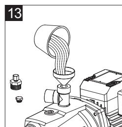
**NOTA:** Se puede tardar varios minutos para llenar las tuberías y la bomba (A) por completo. Inspeccione el nivel del agua en el soporte de descarga. Asegúrese de que el nivel del agua es estable y no hay burbujas de aire.
