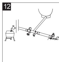
**PRECAUCIÓN!** Nunca instale una válvula de cierre entre la bomba y el tanque, ya que esto puede causar la pérdida por fricción excesiva y puede dañar el interruptor de presión y / o la bomba (A). Si es necesario, sólo se instala una válvula de compuerta completamente abierta (no incluido).
