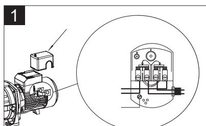
Si usted tenía un interruptor de presión diferente en la bomba antigua (p. 20/40 PSI), **asegúrese de ajustar la presión en el tanque a 28 PSI! Es posible que necesite un compresor de aire para añadir presión de aire. Si usted tiene demasiada presión de aire en el tanque, sólo tiene que pulsar el tallo aire hacia abajo para liberar el aire.**
