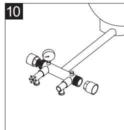
11. La presión del aire en el tanque debe ser de 2 PSI más baja que la de "corte" del interruptor de presión.
