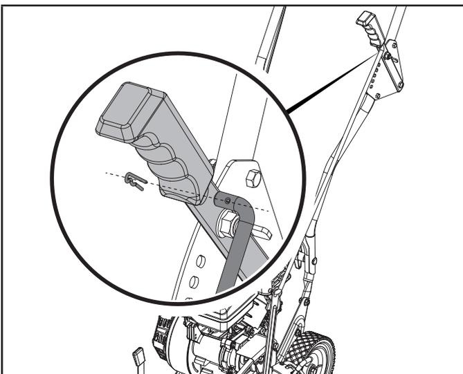
2. Inserte el otro extremo de la varilla de control a través del orificio del brazo de ajuste de la cuchilla y asegúrelo en su lugar con el clip en forma de R.
