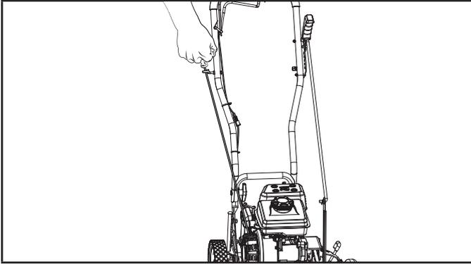
7. A medida que el motor se caliente, mueva la palanca del ahogador a la posición "CORRER".
