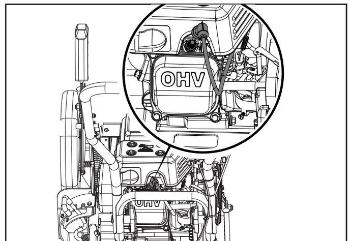
3. Limpie alrededor del tapón de drenaje de aceite para evitar que la suciedad caiga en el cárter. Retire el tapón de drenaje de aceite con una llave de tubo de 10 mm (no incluida).
