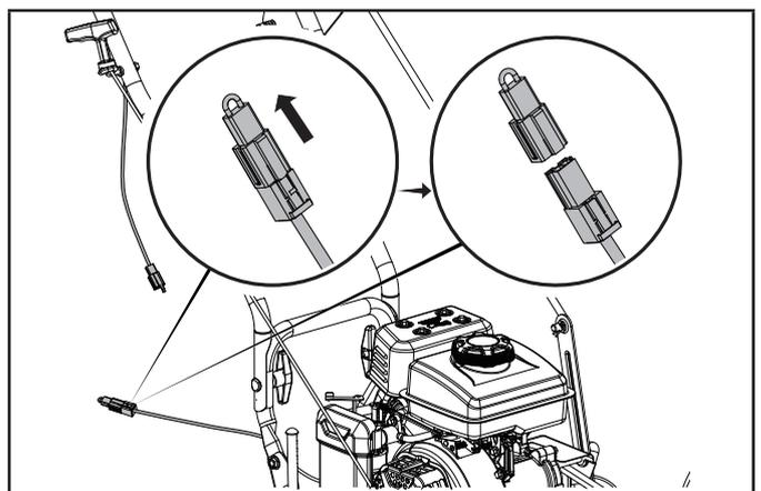
2. Conecte el cable de conexión a tierra del motor al cable de conexión a tierra del mango.
