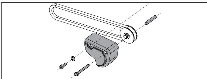
5. Con una llave de 8 mm o una llave de tubo, retire los dos tornillos del protector de la polea delantera y retire el protector.
