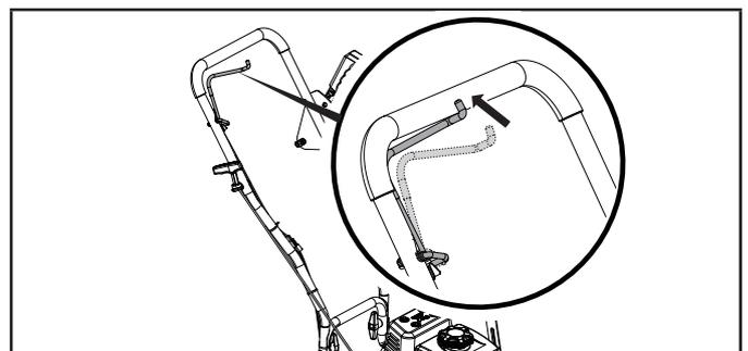
6. Con la mano derecha, tire lentamente de la cuerda de arranque hasta que sienta resistencia y luego tire rápido.
