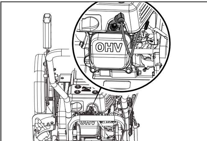
2. Use una herramienta para de bujías (incluida) o una llave de tubo de 5/8 in. (16 mm) (no incluida) para sacar la bujía.
