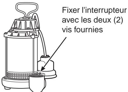
**Figure 3 - Interrupteur à diaphragme**
