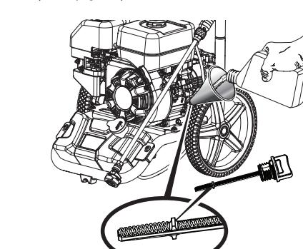
Gire la válvula de combustible a APAGADO antes de agregar aceite.
