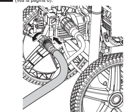
Desenrolle completamente la manguera de jardín o quite la completamente del carrete para evitar la formación de acodaduras.
