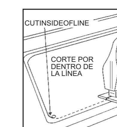
3. Using a saber saw, cut inside of cutout line. Corte por dentro de la linea.
