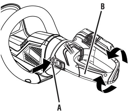
A - Rotating handle button (bouton de la poignée pivotante, perilla del mango giratorio)
