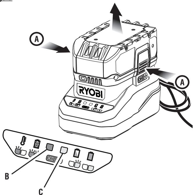
A - Depress latches to remove battery pack (enfoncer les attaches pour retirer le bloc-pile, para extraer el paquete de baterías oprima los pestillos)
