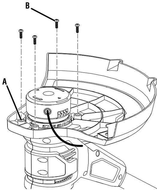
A - Screw holes (orifices de las vis, agujeros del tornillo)
