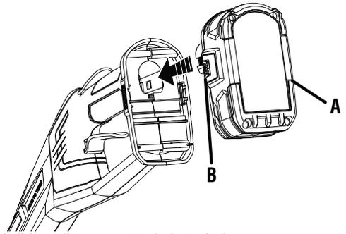
A - Battery pack (bloc-piles, paquete de baterías)
