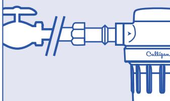
Aligner le filtre assemblé et les bouts des tuyaux, en s'assurant que la direction de l'écoulement d'eau correspond à la direction des flèches sur la tête du filtre. Il est nécessaire d'écartier les tuyaux pour installer le filtre assemblé correctement. À l'aide de deux clés à molette, retenir fermement le raccord d'entrée d'une clé et serrer l'écrou de l'autre. Répéter le processus avec le raccord de sortie.
