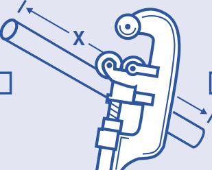
Con un cortatubos o una sierra para metales, corte y retire la sección marcada de la tubería. Lime o lije los bordes filosos en los extremos de la tubería.
