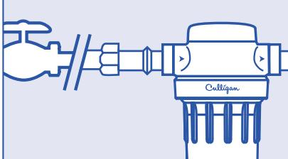
Alinee el ensamblaje del filtro con los extremos de la tubería y asegúrese de que el flujo de agua corra en la misma dirección que las flechas en el cabezal del filtro. Será necesario que separe los extremos de la tubería para instalar el ensamblaje del filtro. Utilice dos llaves inglesas; con una de ellas, sujeté bien el accesorio entrante y, con la otra, ajuste la tuerca. Repita el proceso con el accesorio saliente.
