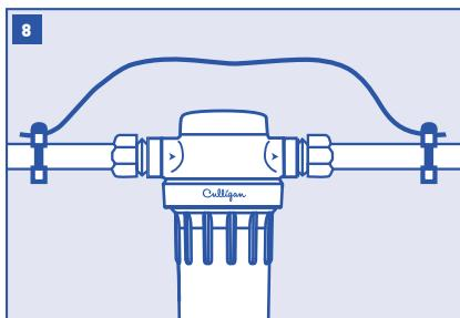
**ATTENTION :** Si les tuyaux servent à mettre à terre le système électrique, les électroménagers ou le système téléphonique, s'assurer d'installer un fil volant.
