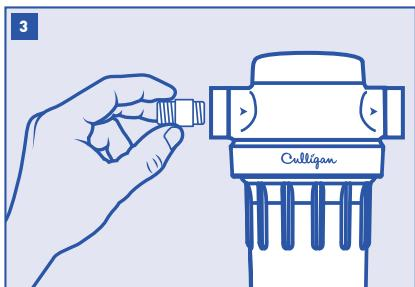
Ensamble todos los accesorios. Coloque manualmente los adaptadores (no incluidos) en el cabezal del filtro. Utilice una llave para ajustarlos bien.
