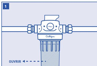
Fermer l'alimentation en tournant le robinet de dérivation de « Off » (arrêt) à « Bypass » (dérivation).
