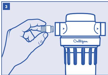
Assembler tous les raccords. Fixer d'abord les adaptateurs (vendus séparément) à la tête du filtre à la main. Serrer à l'aide d'une clé.
