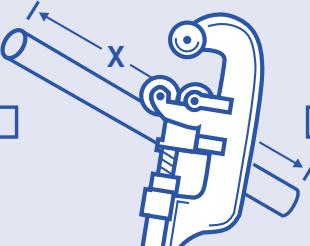
À l'aide du coupe-tuyau ou de la scie à métaux, couper et retirer les sections de tuyau marquées. Limer ou sabler les bouts de tuyau restants.
