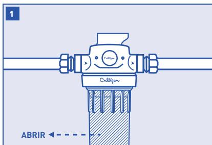
Corte el suministro de agua moviendo la válvula de paso a la posición "Cerrada" o "Paso."
