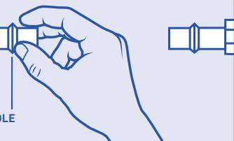
Glisser l'écrou de compression et la bague en laiton sur le bout de chaque tuyau de 1 po.
