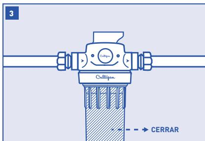
Atornille la parte inferior de la cubierta a la tapa y ajuste con firmeza. **NO AJUSTE DEMASIADO.**
