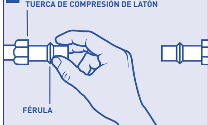
Deslice una tuerca de compresión de latón y un casquillo en cada extremo de la tubería de 1 in.
