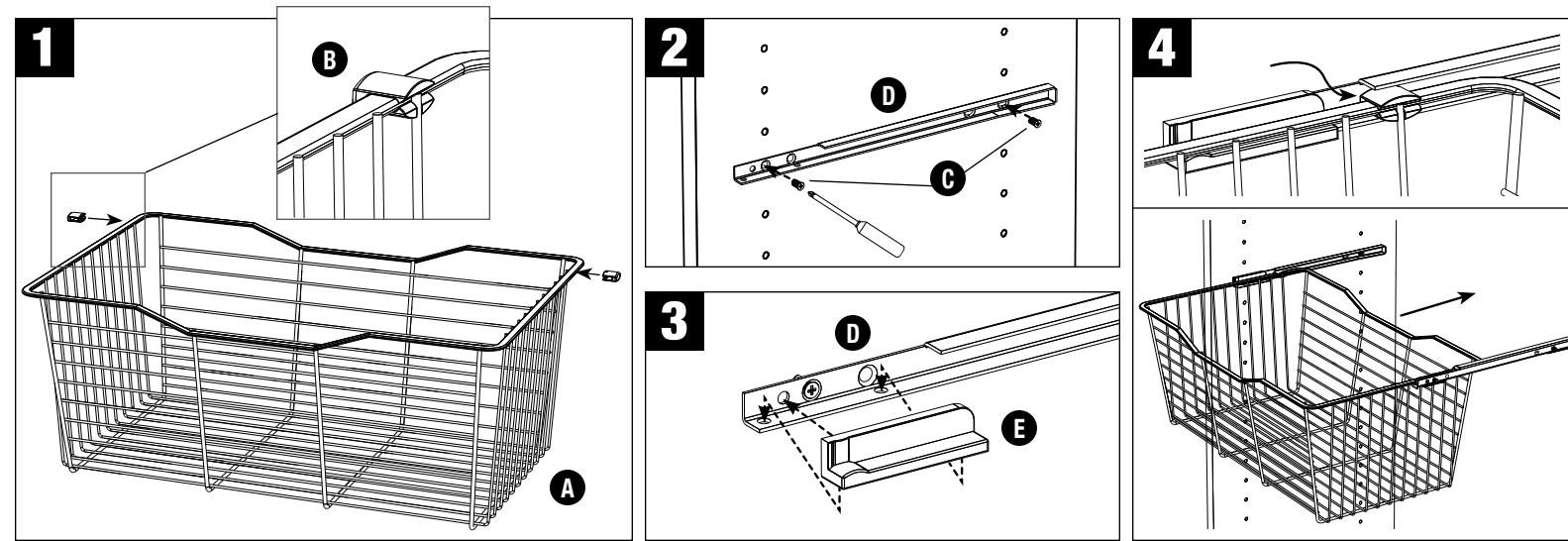
1. Coloque el mecanismo de deslizamiento en el último alambre lateral. Deje el cajón a un lado.
