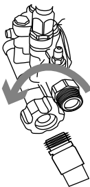
Figure 2-9. Raccord du tuyau d'alimentation en eau
