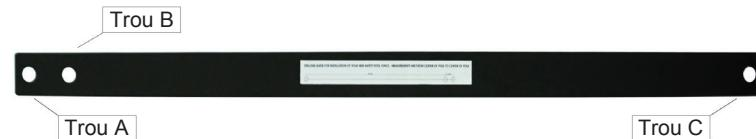
4. Continuez tout autour de la piscine, percez tous les trous en utilisant le gabarit de perçage pour vous guider. Placez le trou « B » marqué sur le gabarit de perçage sur le dernier trou percé. (voir figure 2), puis percez le trou « C ». Répétez cette étape pour chaque 3,7 cm (ou à l'extrémité de chaque unité de barrière), vous devez également percer le trou « A » pour accueillir le poteau de la nouvelle unité de barrière.
