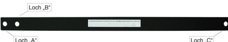
4. Fahren Sie mit dem gesamten Pool fort und bohren Sie alle Löcher mithilfe der Bohrschablone. Platzieren Sie das auf der Bohrschablone markierte Loch „B“ über dem zuletzt gebohrten Loch.(siehe Abbildung 2), dann bohren Sie durch das Loch „C“. Wiederholen Sie diesen Schritt alle 3,7 M (oder am Ende jeder Zauneinheit). Sie müssen auch das Loch „A“ durchbohren, um die Stange der neuen Zauneinheit aufzunehmen.
