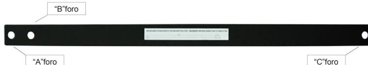
4. Continuare intorno all'intera piscina, praticare tutti i fori utilizzando la dima di foratura come guida. Posizionare il foro "B" segnato sulla dima di foratura sull'ultimo foro praticato. (vedere la figura 2), e poi praticare il foro "C". Ripetere questo passo per ogni 3,7 M (o alla fine di ogni gruppo di recinzione), è inoltre necessario praticare il foro "A" per ospitare il palo dal nuovo gruppo di recinzione.
