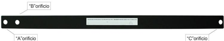
4. Continúe alrededor de toda la piscina, taladre todos los orificios usando la plantilla de perforación como guía. Coloque el orificio "B" marcado en la plantilla de perforación sobre el último orificio perforado (vea la figura 2), y luego taladre el orificio "C". Repita este paso por cada 3,7 M (o al final de cada unidad de valla), también debe perforar el orificio "A" para acomodar el poste de la nueva unidad de valla.
