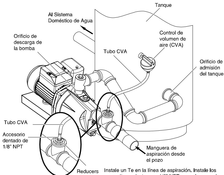
Instale un Te en la línea de aspiración. Instale los manguitos reductores a 1/8" NPT para el accesorio dentado. Instale el tubo CVA entre el accesorio dentado y el orificio en la parte inferior del CVA (que está montado en el tanque).
