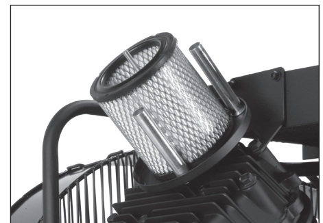
Figure 19 - Filtro de aire
