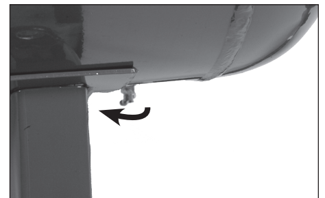
Figura 16 - Drenaje manual del tanque
