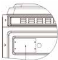
Défecteur de port de câblage
