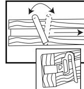
Faire glisser la plus petite extrémité de la pince dans la rainure située à l'arrière de la bordure de bois. Déplacer la pince légèrement d'avant en arrière à travers la rainure afin de bien positionner la pince. Placer les pinces séparées par une distance qui ne dépasse pas 91,44 cm et un maximum de 30,48 cm des extrémités de la bordure de bois.
