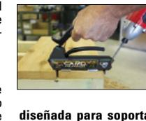
Con la Marksman Pro-X1 asentada en la tabla, ponga un Sujugador Invisible CAMO en las guías de tornillos en ambos extremos de la herramienta Marksman Pro-X1. Nota: Si la herramienta no está asentada sobre la tabla de la plataforma, los tornillos se desplazarán hacia afuera de las guías de tornillos.
