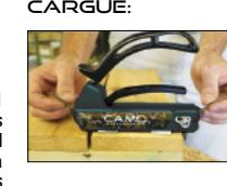
Comenzando en un extremo de la tabla (recomendamos un mínimo de 1 pulgada desde los extremos de las tablas), apriete el mango del gatillo del Marksman Pro-X1 y ponga la herramienta sobre la tabla. Afloje el asa del gatillo dejando que los espaciadores se contraigan y agarren la tabla. Una herramienta bien asegurada se aprieta firmemente a la tabla. Las patas de la herramienta deben estar planas sobre las superficies de la tabla y la herramienta debe estar centrada sobre la viga.
