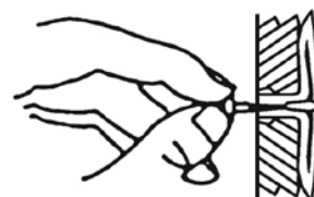
Fig. 19a - Instalación de separadores de colgador de pared en el calefactor
