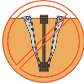
Hanger over-spread Soporte demasiado abierto
