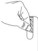
5. Installer l'antenne à l'emplacement désiré puis la maintenir appliquée contre le mur pendant 10 secondes.
