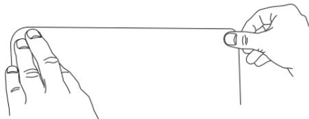
6. Cesser d'appliquer l'antenne contre le mur et vérifier qu'elle est fermement fixée au mur. Puis exercer une pression pendant 30 secondes supplémentaires.
