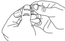
3. Enlever la doublure antiadhésive rouge. Appliquer le morceau de ruban adhésif sur un des coins supérieurs au dos de l'antenne. Répéter l'opération pour l'autre coin supérieur. Puis placer un morceau unique de ruban adhésif, orienté vers le bas, sur la partie métallique au milieu et au bas de l'antenne.
