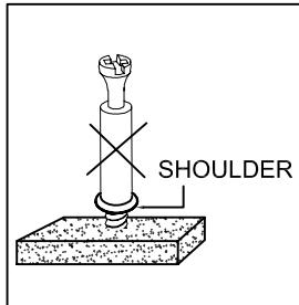
NOTE: TURN THE CAM-BOLT SCREWS UNTIL THEY ARE TIGHT, THE SHOULDER SHOULD BE AGAINST THE SURFACE OF THE PART.
