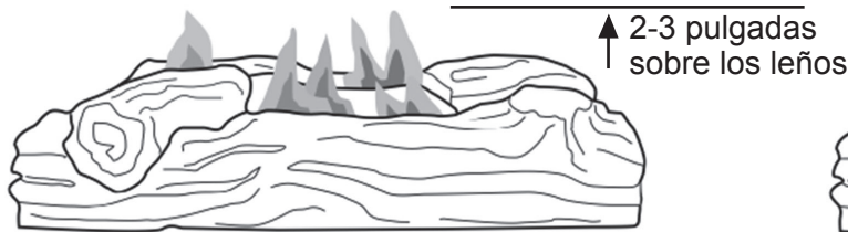
Fig. 22 - Patrón correcto de la llama del quemador
