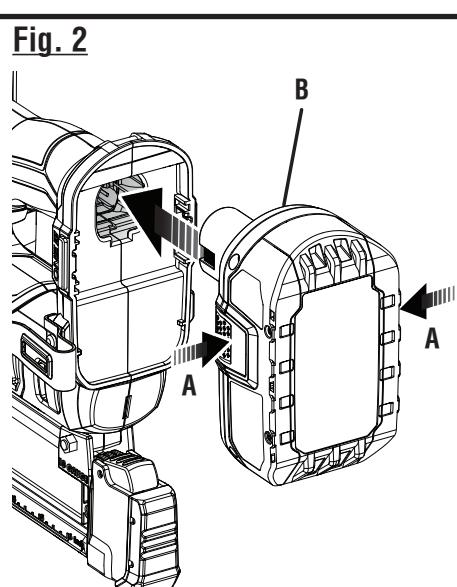
A - Depress latches (appuyer sur les loquets, oprima los pestillos)
