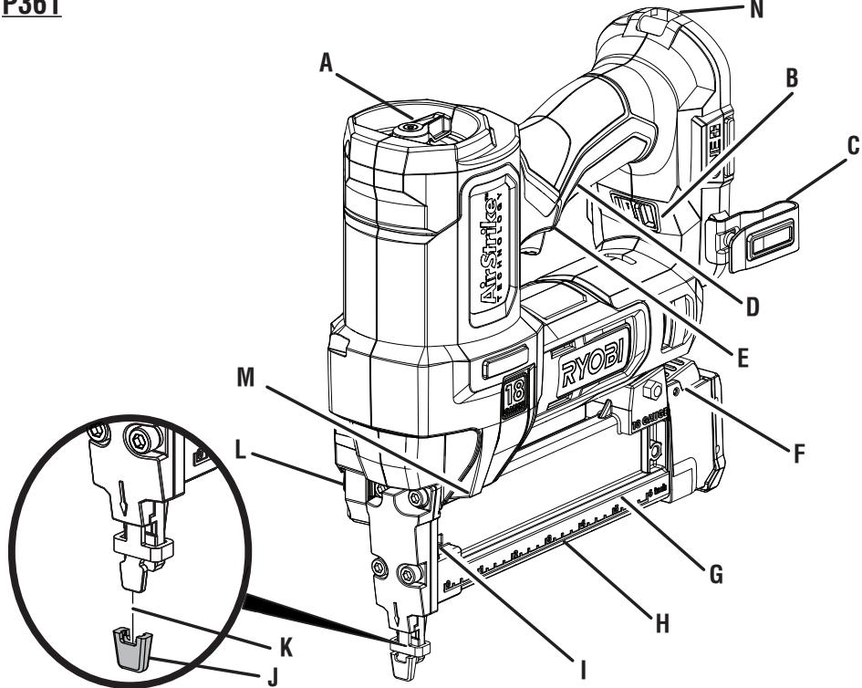
A - Air pressure dial (cadran de pression d'air, cuadrante de presión de aire)
