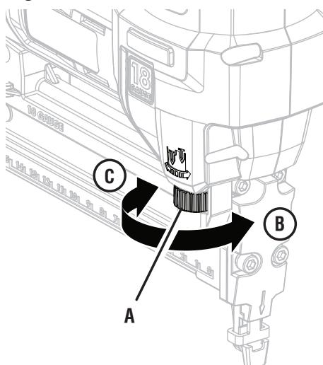
A - Depth of drive adjustment (réglage de profondeur d'enfoncement, ajuste de la profundidad de introducción)
