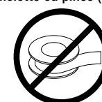
L'utilisation d'adhésif à tuyauterie n'est pas recommandée.
