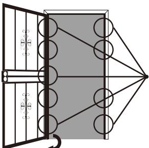
Utilizar el pre-perforados oculta los orificios de los tornillos en la parte interior del lado de las bisagras y la cerradura del Z-bar para mayor resistencia a manipulaciones.
