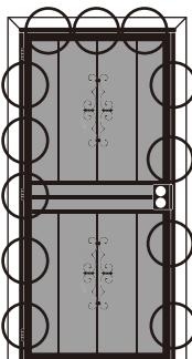
5. Abrir la puerta y quitar las dos pre-hang entre corchetes. Cierre la puerta y perforar los orificios restantes en el Z-bar con una broca de 5/32" y fijar con los tornillos de cabeza Phillips siempre manteniendo al mismo tiempo revelan una constante entre el marco de la puerta y los Z-bar.
