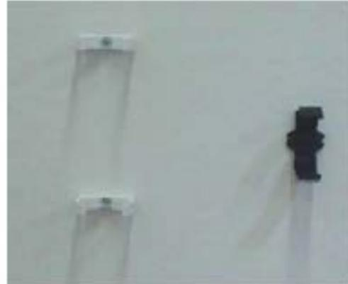
**Fig. 4 Clips de fijación para el sistema y bomba de permeado**
