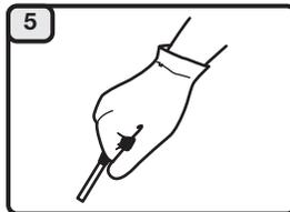
Tirez sur la corde de démarrage en effectuant un mouvement contrôlé et ferme à **5 reprises**.
