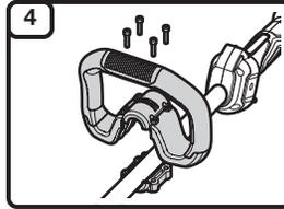
Appuyez sur la base de la poignée et maintenez-la contre la face inférieure du boîtier d'arbre supérieur. Enfoncez le haut de la poignée sur la base de la poignée jusqu'à ce qu'elles s'enclenchent. Insérez les boulons (x4) dans les trous (x4). Serrez les boulons, mais pas complètement. Utilisez une clé Allen de 4 mm (5/32 po).
