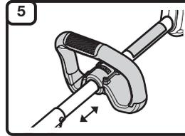
Maintenez l'unité en position d'utilisation. Déplacez le manche vers le haut ou le bas sur le tube supérieur pour trouver une position confortable. S'assurer que la poignée est placée au-delà de l'extrémité de l'étiquette de sécurité. Serrez les boulons jusqu'à ce que la poignée soit bien fixée.
