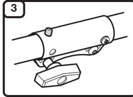
Poussez l'accessoire directement dans le coupleur jusqu'à ce que le bouton de déverrouillage s'enclenche fermement dans le trou à 90°. Tournez le bouton dans le sens contraire des aiguilles d'une montre pour serrer le coupleur.
