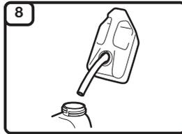
Placez l'appareil afin que le bouchon du réservoir soit tourné vers le haut. Retirez lentement le bouchon du réservoir d'essence. Remplissez le réservoir d'essence. Revissez le bouchon du réservoir. Éloignez l'appareil à 9,1 mètres (30 pieds) au moins du bidon de carburant et du site de ravitaillement avant de démarrer le moteur.
