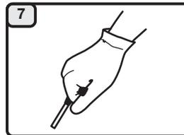
Tirez sur le câble de démarreur en un mouvement contrôlé et ferme à **5 reprises** pour démarrer le moteur.
