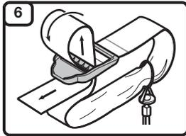
Poussez la courroie à travers la fente centrale de la boucle. Repliez la sangle et faites-la passer dans la fente inférieure de la boucle. Placez la bandoulière par-dessus la tête de l'opérateur et sur l'épaule gauche.
